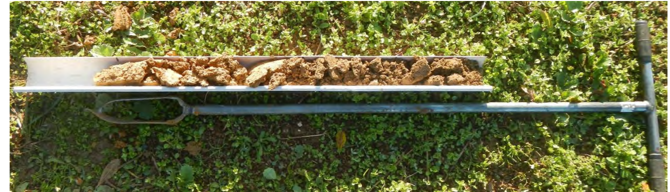
Photo 1 : Exemple de carottage sur une profondeur de 90 cm (Source : AEPE-Gingko)
