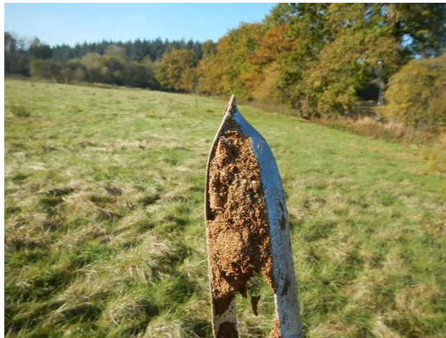
Photo 6 : Traces d'hydromorphie observées sur le sondage n°14
